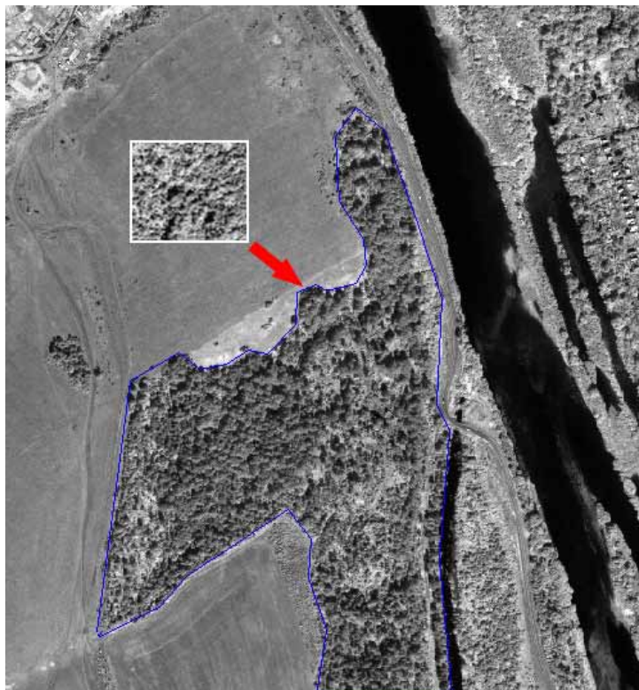
Рис. 4. Результат выделения полигона на снимке QuickBird по образцу с заданной текстурой (образец текстуры показан в левом верхнем углу иллюстрации).
